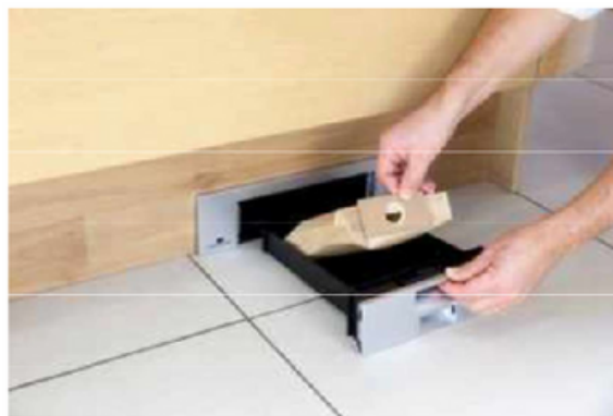
6. Při vyjímání držte sáček svisle, abyste zabránili vysypání nečistot. Sáčky by měly být vyprázdněny každých 12 týdnů nebo když jsou plné. Při vyprazdňování nebo výměně pytlů lze celou zásuvku odnést do odpadu. Při opětovném vkládání sáčku se ujistěte, že jsou 3 kartonové výstupky zcela zasunuty.
