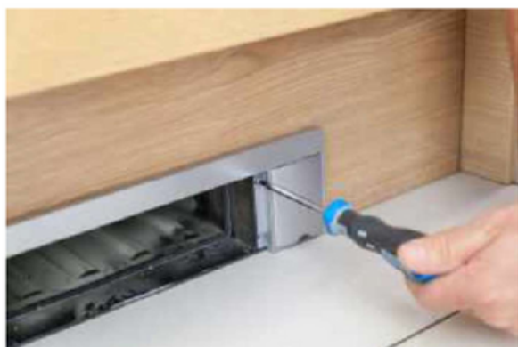
22. Připevněte čelní desku zpět ke stroji a vložte 4 šrouby.
