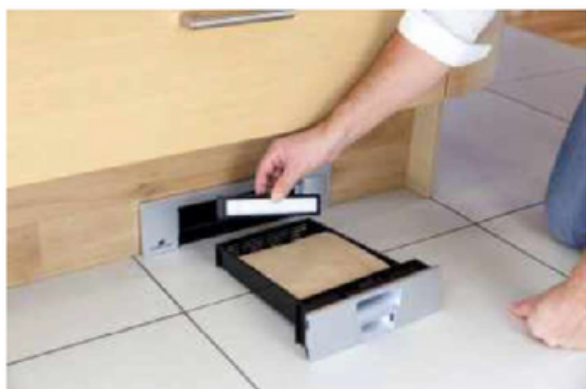
7. Doporučuje se čistit filtr každých 12 měsíců nebo pokud je při vizuální kontrole špinavý. Chcete-li vyčistit, vyjměte a poklepáním setřeste přebytečný prach. Filtr lze jemně umýt teplou vodou. Před opětovným vložením nechte důkladně uschnout.
