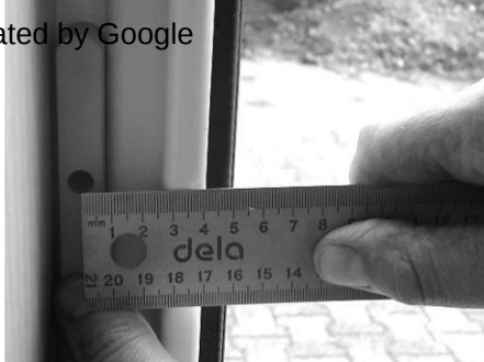
1 – Změřte rozměr A (v tomto případě 50 mm)
